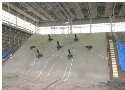
写真 2-1 実大模型斜面降雨実験状況
